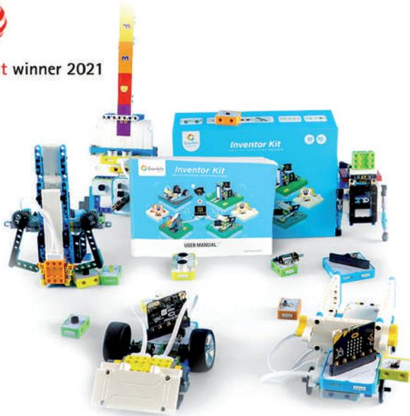
“Inventor Kit” è il kit di programmazione della serie Crowbits che utilizza **Micro:bit come console centrale** e combina moduli elettronici con il software di programmazione grafica “Letscode”. Attraverso la semplice programmazione drag-and-drop, gli utenti potranno creare progetti interessanti e creativi in brevissimo tempo.
