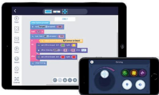
mBot converte il programma da grafico a testuale (in righe di codice sorgente), semplificando il passaggio dalla programmazione a blocchi di Scratch alla programmazione testuale di Arduino. mBot si può programmare testualmente in CC++ direttamente nell'ambiente Arduino.
